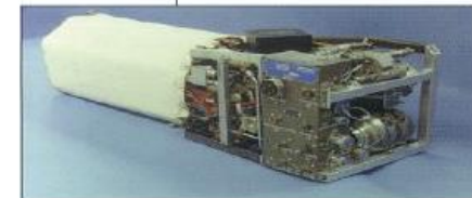
宇宙船アポロ以降有人宇宙衛星に 燃料電池搭載 (アルカリ型) AFC on Board Space Ship APOLO
