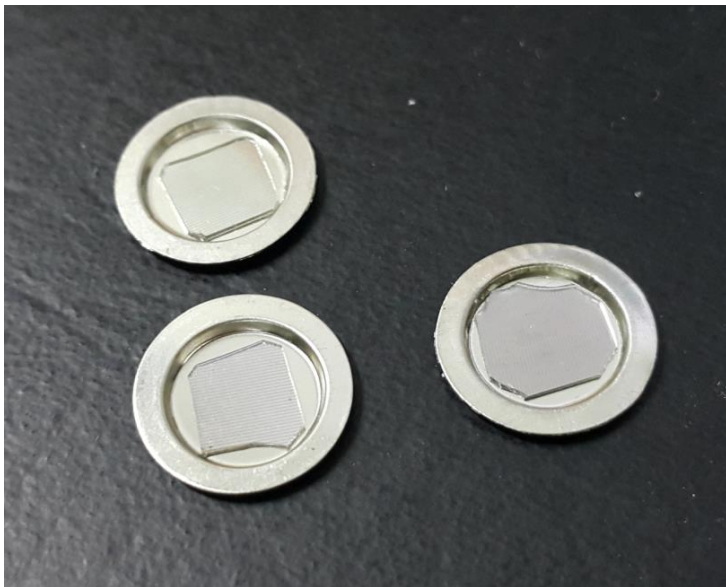
시료준비 완료 (절단 후 시료홀더 장착)
