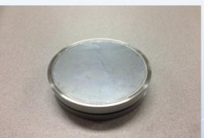
레이저 용접 후 표적 완성 (직경 60mm, 두께 16.6mm)
