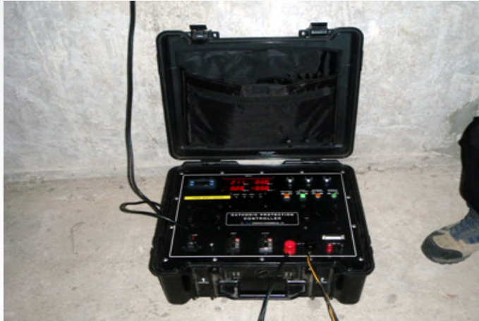
DCVG 송신기 설치
