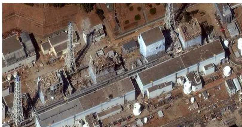
그림 A.2.3-2. 수소가스 폭발 후의 후쿠시마 제1원전 1~4호기 외부 모습
