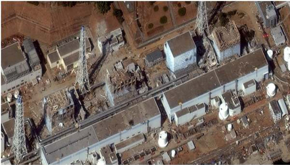
<그림 3.9> 후쿠시마 제1원전에서의 수소가스 폭발로 인한 원자로건물 손상
