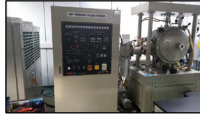
Hot isostatic press
