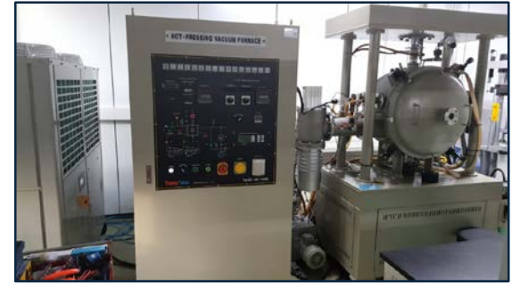
Hot isostatic press
