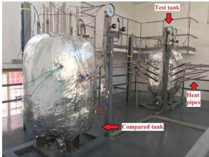
그림 2-2.16 정상, 과도상태의 용융염 온도 거동 평가를 위한 실험장치
