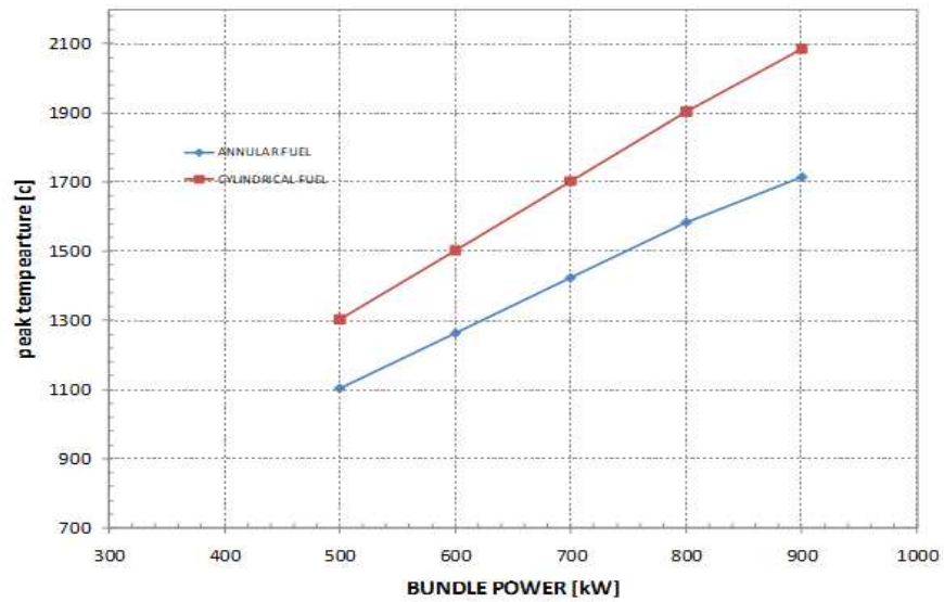
그림 3-2.3 기존 CANDU-6 37봉 핵연료다발 외환봉과 동일한 연료질량을 갖는 환형 핵연료의 최대온도 비교 결과
