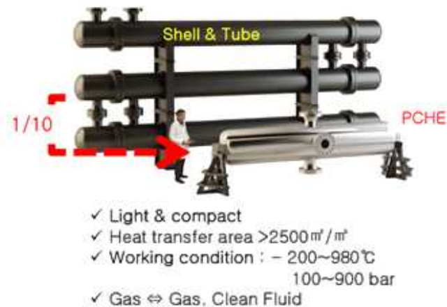
그림 3-1.11 인쇄기판형 열교환기 예시
