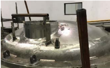
顶盖组件：已完成泵通道套管焊接
