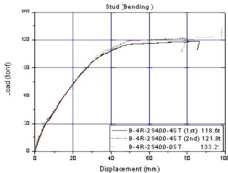
Fig 7. Load-Displacement curve w.r.t. stud
