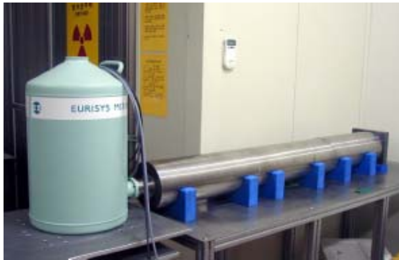
그림 3-3 UO_2 소결체 감마선 에너지 분석에 사용된 Ge-계측기
