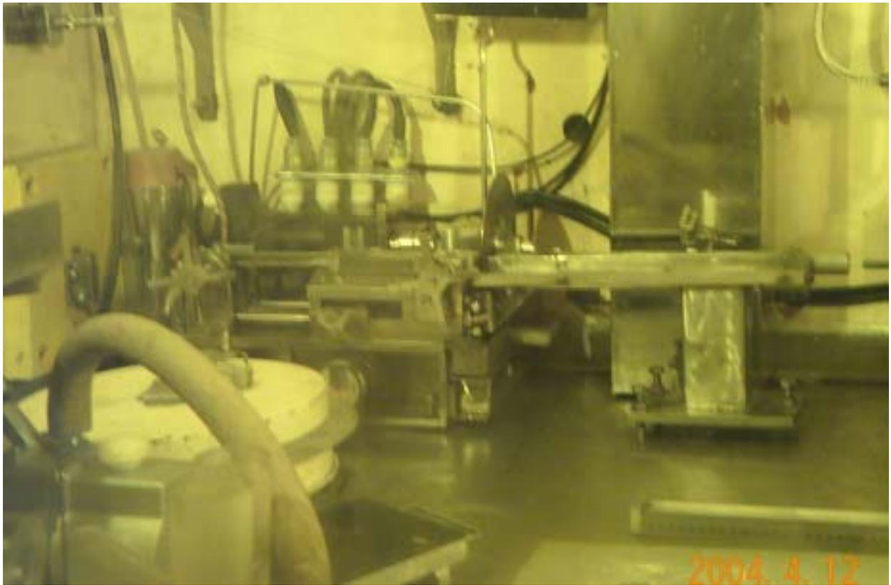
그림 1. 핵연료봉 절단장치 사진
