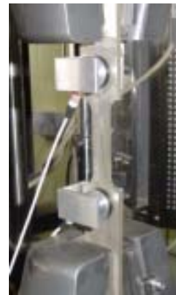
그림 3. 인장시험편과 AE센서 설치 사진
