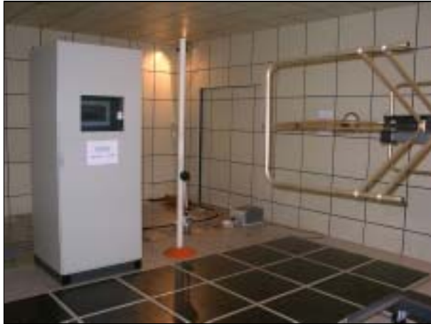
그림 8. 전기장 방사 내성 시험 ( 30 MHz ~ 1 GHz)
