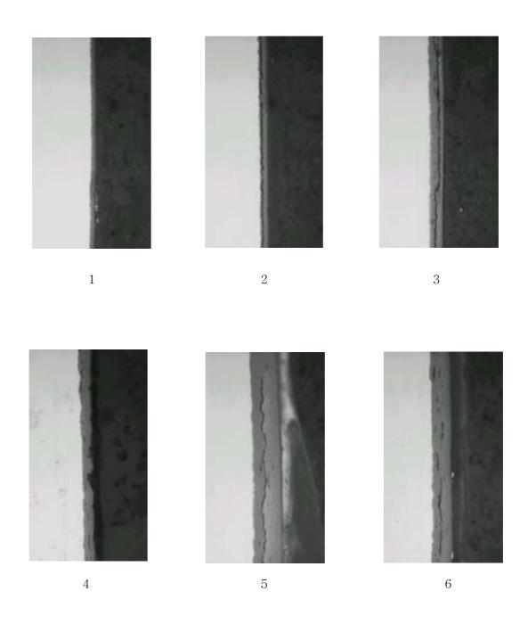
그림 5. Q17-M14 연료봉 하단으로부터 (1)496 (2)1,149 (3)1,198 (4)2,306 (5)3,024 (6)3,397mm 위치에서의 피복관 외면 산화막의 형상
