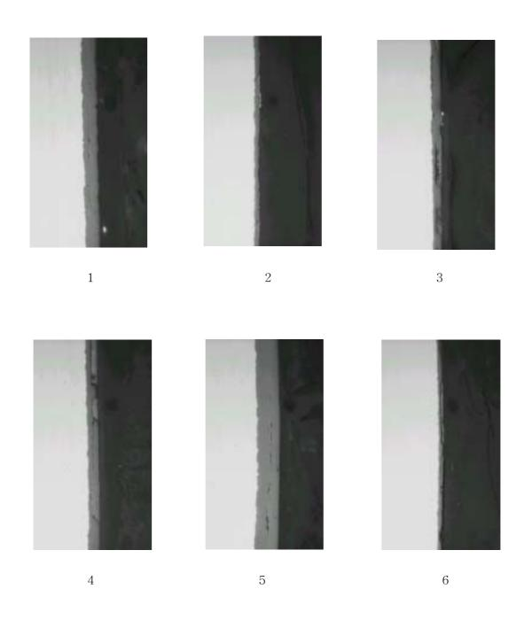
그림 3. Q17-A03 연료봉 하단으로부터 (1)765 (2)1,140 (3)2,180 (4)2,772 (5)3,022 (6)3,388mm 위치에서의 피복관 외면 산화막의 형상
