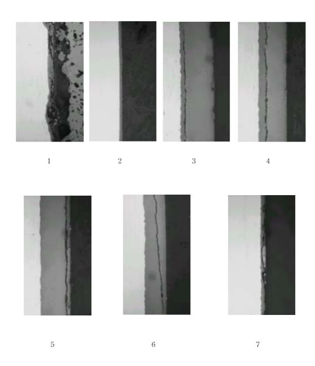
그림 7. R19-K13 연료봉 하단으로부터 (1)27 (2)45 (3)1,486 (4)2,022 (5)2588 (6)3,505 (7)3,838mm 위치에서의 피복관 외면 산화막의 형상
