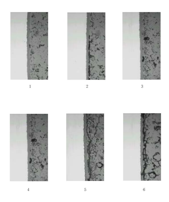
그림 2. Q17-D11 연료봉 하단으로부터 (1)486 (2)1,146 (3)1,994 (4)2,410 (5)3,020 (6)3,390mm위치에서의 피복관 내면 산화막의 형상
