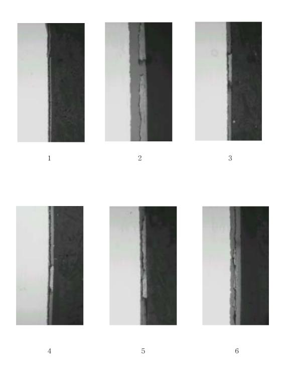
그림 1. Q17-D11 연료봉 하단으로부터 (1)486 (2)1,146 (3)1,994 (4)2,410 (5)3,020 (6)3,390mm위치에서의 피복관 외면 산화막의 형상
