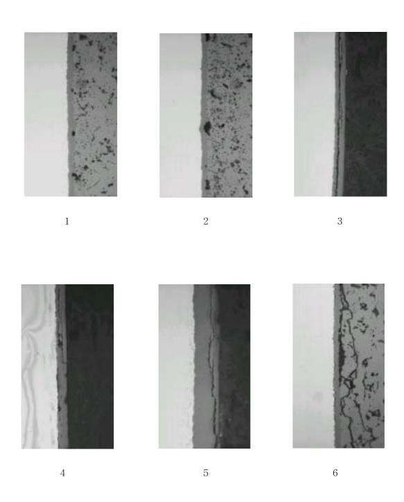
그림 6. Q17-M14 연료봉 하단으로부터 (1)496 (2)1,149 (3)1,198 (4)2,306 (5)3,024 (6)3,397mm 위치에서의 피복관 내면 산화막의 형상
