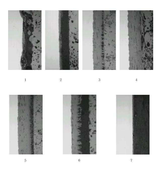
그림 8. R19-K13 연료봉 하단으로부터 (1)27 (2)45 (3)1,486 (4)2,022 (5)2588 (6)3,505 (7)3,838mm 위치에서의 피복관 내면 산화막의 형상
