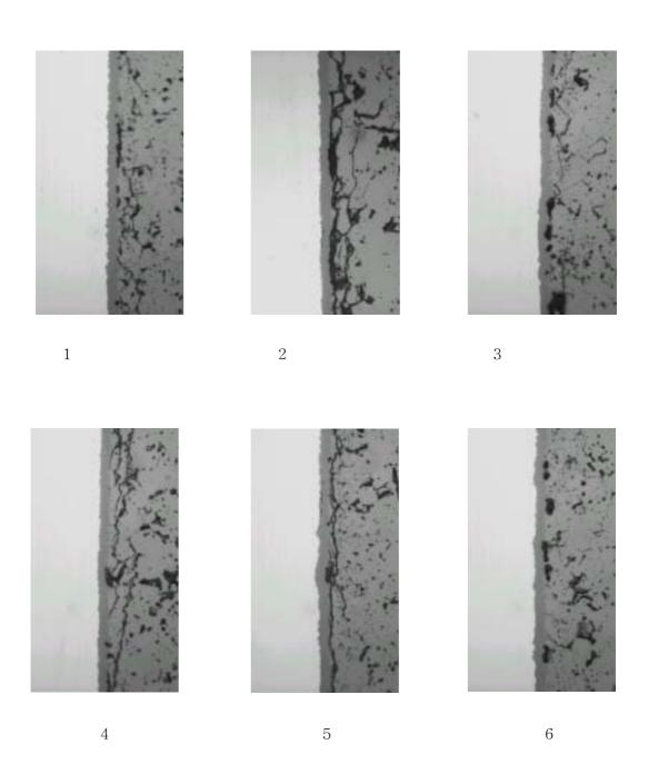
그림 4. Q17-A03 연료봉 하단으로부터 (1)765 (2)1,140 (3)2,180 (4)2,772 (5)3,022 (6)3,388mm 위치에서의 피복관 내면 산화막의 형상
