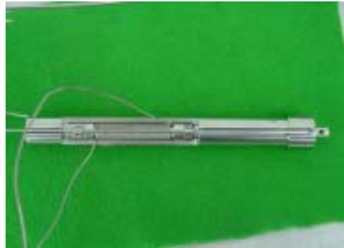
그림 3 시편부와 히터(조립 후)
