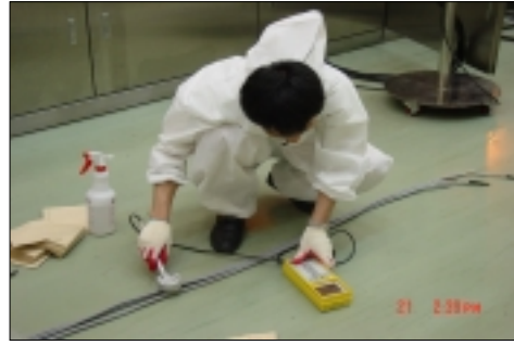
그림 6. 핫셀내부에서 인출한 전선들의 오염도 측정.
