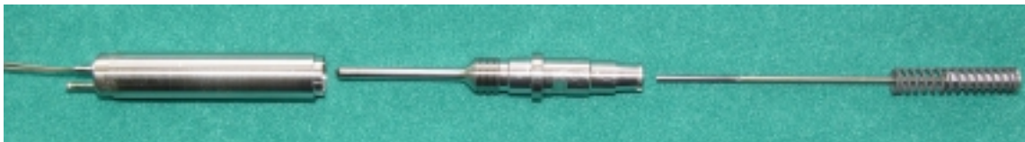
(a) LVDT와 Core의 결합 전 상태
