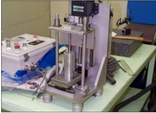
Fig. 4. 고착한 시편해체용 시편홀더 프레스 기기.
