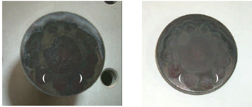
그림 5. CsI로 오염된 고착성 시편 2의 제염 전후의 사진(제염 조건: 분사압력 4 kg/cm 2 , 분사시간 20초, 분사거리 20cm).
