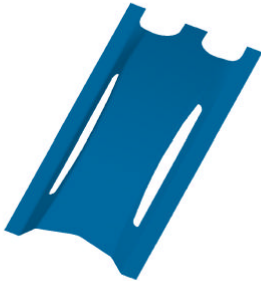
그림 3 새이중판 노즐형 지지격자의 스프링판 형상
