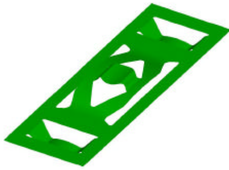
그림 2 최적화 H형 지지격자의 스프링판 형상
