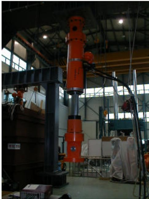
그림 6. 앵커기초의 성능시험을 위하여 설치된 Actuator 설치모습
