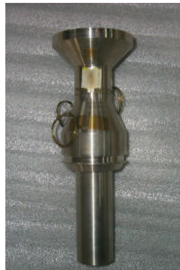
그림 5. 노즐급수헤더에 장착된 스트레인 게이지 사진
