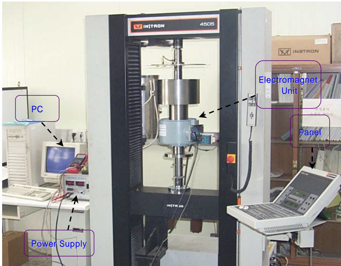
그림 3 인장시험기에 설치된 전자석 장치
