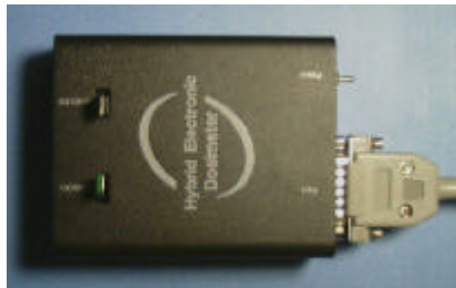
그림 8. 제작된 통합 방사선 감지기모듈(외관) 그림 9. 통합 방사선 감지기 모듈(내부)
