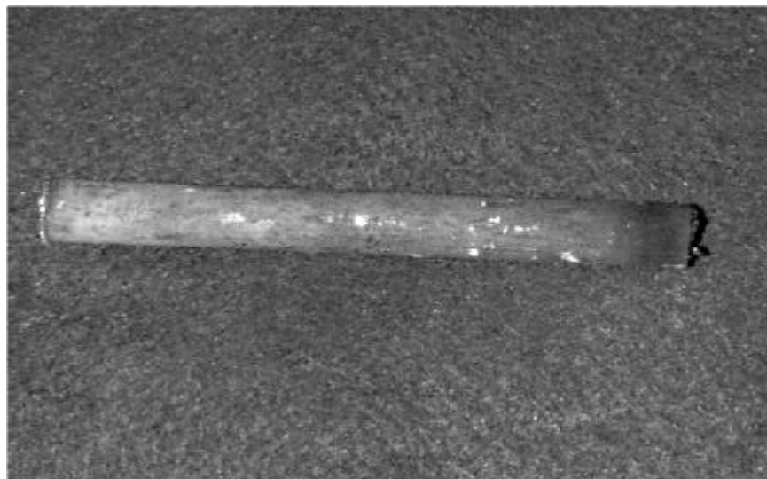
그림 7. 급냉 잉곳의 공기중 방치 전 모습
