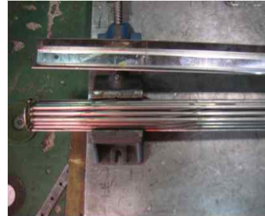
Fig. 2 19 rod bundle test section
