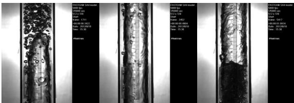
Fig. 9 Slug flow for j_g = 0.5 \text{ m/s} , j_f = 0.1 \text{ m/s}
