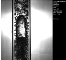
Fig. 7 Slug flow for j_g = 0.2 \text{ m/s} , j_f = 1.0 \text{ m/s}
