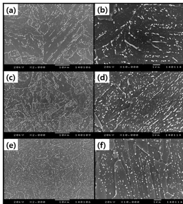
**Figure 1 Microstructure of SA508 low alloy steels: (a), (b) Gr.3 Cl.1, (c), (d) Gr.3 Cl.2, and (e), (f) Gr.4N**
