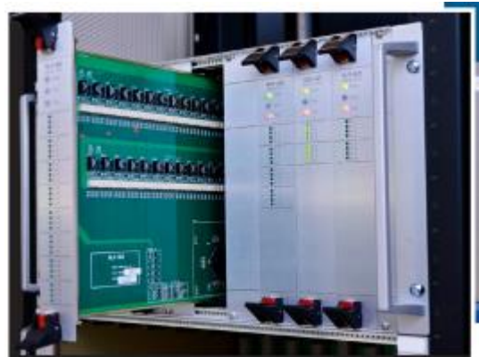
Fig. 6. Example of ALS chassis [5].
