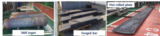
Fig. 3. ARAA-3 18 ton fabrication
