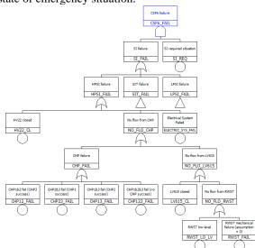
Fig. 4. CSF6 Logic Diagram
