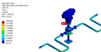
(d) Combined thermal, pressure and seismic loads
