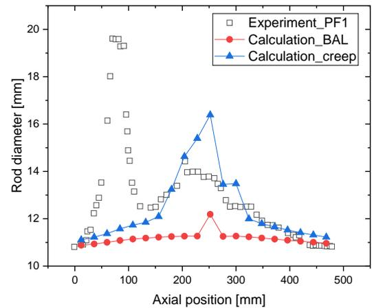
Fig. 4. Fuel rod diameter
