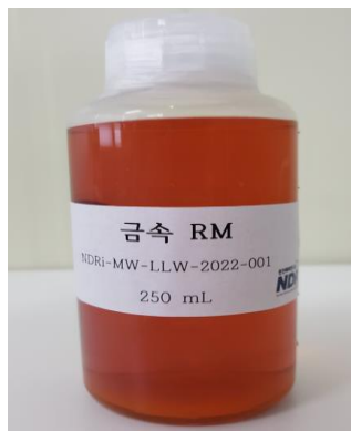
Fig. 1. A SUS 304 Reference Material containing Sr-90, Cs-134, Cs-137 and Co-60
