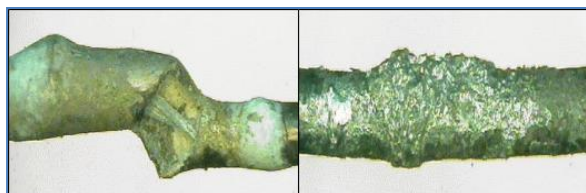
Fig. 2. Brazing after a twist(Inconel/STS310)
