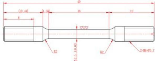
Fig. 4. Tensile specimens
