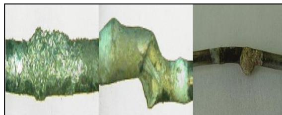
Fig. 4. Brazing after a twist (STS304L/Inconel/STS310)
