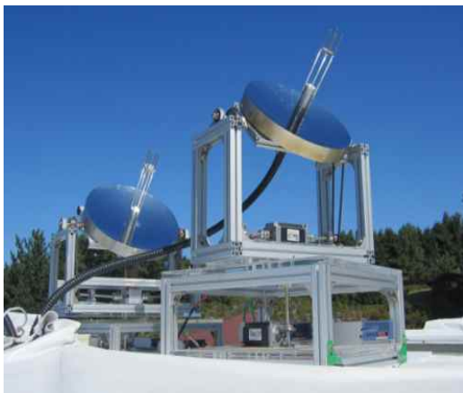
Fig. 1. The daylighting system using mini dish module.
