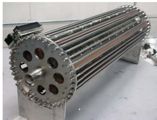
Fig. 3. A fabricated EM pump.
